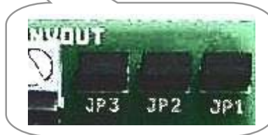
Fig. 14 Detaliu cu jumperii de selecție a intrărilor de semnal video de pe placa dozei de selecție video DSV.41A
