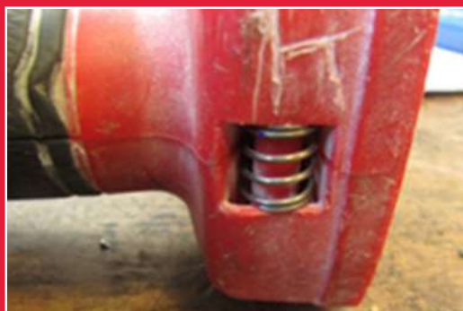
Arc asamblat din exterior, dovedind deschidere neautorizată a sculei
